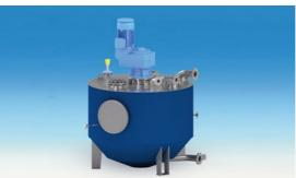
Vertikaler zylindrischer Mischtank mit einem Volumen von 3 m³ mit Ölheizung, Not-Aus-Sensor und Mischvorrichtung. Die weiche Ölheizung ermöglicht eine präzise Temperaturkontrolle in allen technologischen Phasen der Produktion. Die zylindrische Form des Tanks schließt die Bildung stagnierender Zonen aus, da das Volumen des Tankkörpers vollständig abgedeckt wird.
